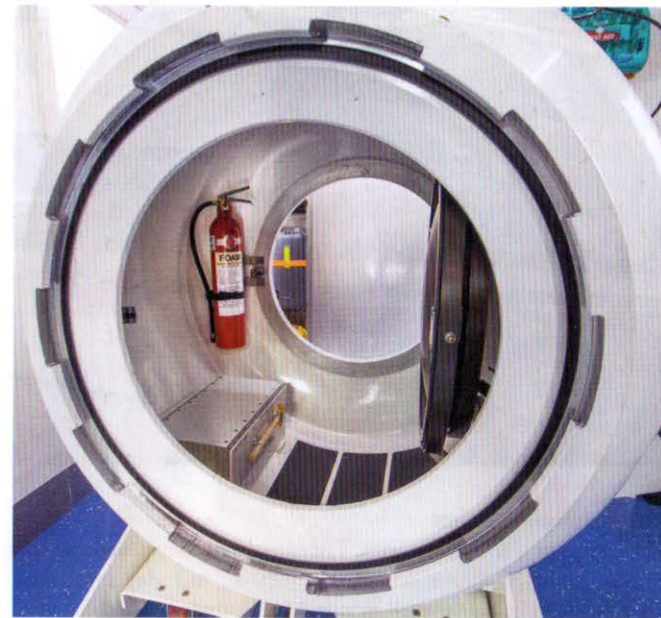
Die Schleuse kann abgetrennt werden. Der Ringbajonett-Anschluss ist gut sichtbar. Damit kann die Druckkammer an stationäre Kammern druckdicht angeschlossen werden.
